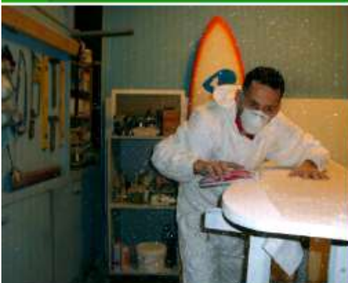
© Čukič: izdelava deske za surfanje iz spenjenega polistirena.
