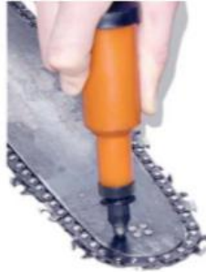
Mazalka za mazanje motome žage
