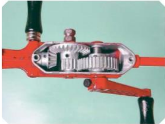
Odprt ročni vrtalni stroj
