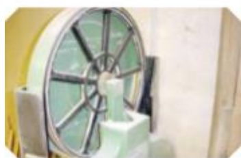
Vrteča os pri tračni žagi
